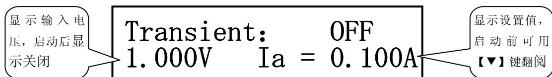
在其它负载模式下，按【SHIFT】+【TRAN】键进入动态测试模式，按【ON/OFF】启动或停止动态测试。
