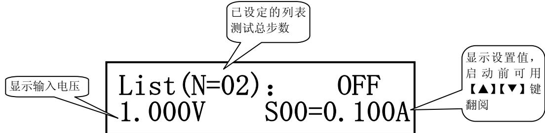
启动列表测试前应首先对相关参数进行设置，按【SHIFT】+【S\_LIST】进入列表参数设定菜单。详细请参阅 3.4.5 列表测试设置菜单。
