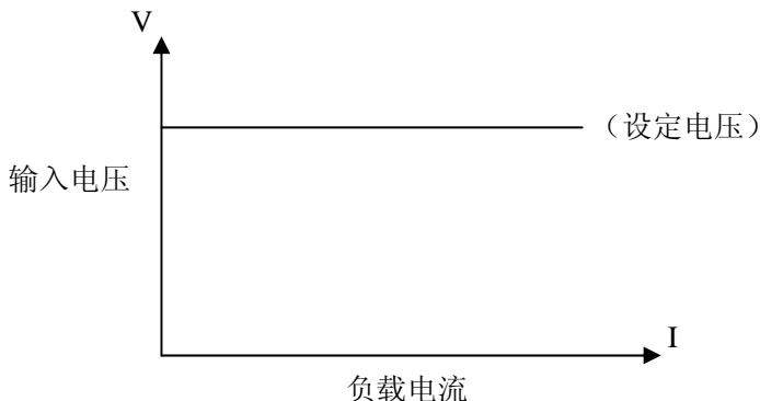
在其它负载模式下,按【V-SET】键进入定电压模式,用【ON/OFF】键启动或停止工作。
